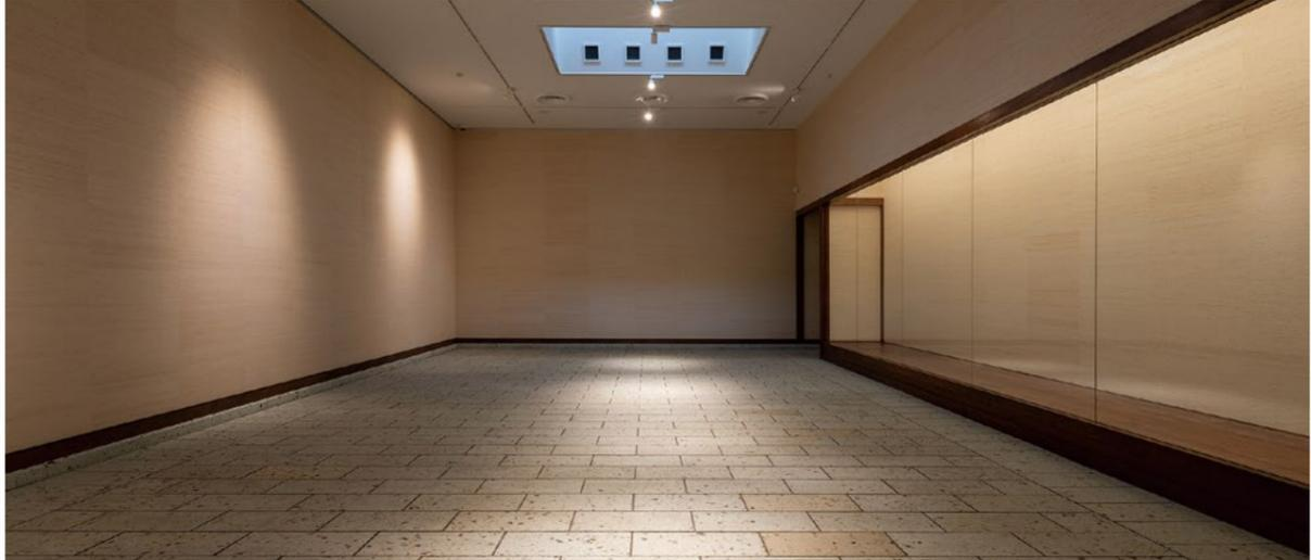
大谷石の床面と葛布の壁面による改修後の大展示室。右側は新設展示ケース。
